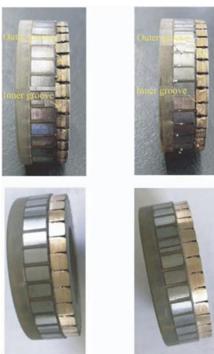
**摘要:** 航空光电雷达电机换向器部位使用的纯铜材料在服役中容易发生表面损伤，传统红外激光沉积纯铜材料过程中激光吸收率较低。采用蓝光激光器对纯铜电机换向器失效部位进行送粉式激光沉积修复（所用粉末为 Cu-15Sn），研究蓝色激光工艺参数对修复形貌及修复区组织性能的影响。采用光学显微镜、扫描电镜及附带能谱仪、显微硬度计、微型摩擦磨损试验仪表征和测试修复区的微观组织、显微硬度及耐磨性能。结果表明：蓝光激光可以在较宽的工艺参数窗口范围获得良好的修复层。修复层为典型的枝晶结构，由铜固溶体枝晶和铜锡金属间化合物共晶组成；平均显微硬度为铜基体硬度的 2.24 倍，修复区相对耐磨性为基体的 2.37 倍。修复区相对于基体硬度和耐磨性提升的原因在于快速凝固条件下形成的细小非均匀枝晶结构（固溶体和金属间化合物的混合结构）和固溶强化效应。铜基体和修复区磨损机制均为磨粒磨损、氧化磨损及黏着磨损。其中修复区主要为粘着磨损和氧化磨损，铜基体为粘着磨损和轻微氧化磨损。研究结果能够为电机换向器部位纯铜材料的高效修复提供数据支撑和理论基础，推进蓝色激光沉积再制造技术在有色金属加工领域的应用。
