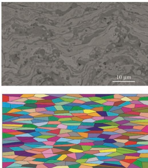
**摘要:**对高温摩擦磨损工况下多相复合涂层的热-力耦合应力场的模拟研究尚不充分。基于Voronoi多边形建立NiCr-Cr<sub>3</sub>C<sub>2</sub>-CaF<sub>2</sub> / BaF<sub>2</sub>多相复合涂层的晶体微观有限元模型,模拟复合涂层中各相的占比、分布形态和热-力学参数,求解得到热-力耦合工况下的von Mises应力和第一主应力分布。结果表明:在高温摩擦工况下,多相复合涂层的应力显著高于均匀涂层,尤其是在硬质相尖端附近易产生局部高应力区域,改善相的形态将锐角钝化能够有效缓解局部高应力现象;热-力耦合应力场与黏结相和硬质相的弹性模量密切相关,通过调节各相模量能够有效调控复合涂层的Mises应力和拉应力值。基于微观有限元方法的热-力耦合应力场模拟可为高温摩擦磨损工况下多相复合涂层的优化设计提供理论依据。
