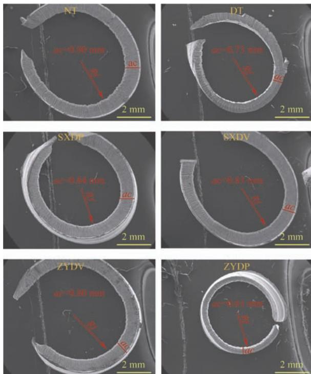
**摘要:** 基于铝合金材料切削的现状和需求, 针对单一织构刀具存在的抗黏减摩性能不足的问题, 将不同织构应用于刀-屑接触区域, 提出刀具前刀面分区异构的思想。利用皮秒激光在刀具黏结区与滑移区分别加工凹坑和沟槽, 并调整沟槽的取向 (平行 / 垂直于主切削刃), 得到上下型 (SXdV 和 SXDP) 和左右型 (ZYDV 和 ZYDP) 四种复合织构刀具。对 6061 铝合金进行湿切削试验, 研究不同区域内添加不同织构对刀-屑接触表面摩擦状态的影响。研究结果表明, 对比无织构和单一织构刀具, ZYDP 复合织构刀具展现了更好的切削性能。具体表现如下: 与无织构刀具相比, ZYDP 刀具的主切削力降低 30.7%, 刀面黏结面积减少 63.9%, 切屑卷曲半径减少 27.4%。合理的复合织构方案可以明显改善刀具切削过程中的黏结磨损问题, 延长了刀具寿命。复合织构方案的提出以及相应的激光加工过程可为织构刀具的设计及实际应用提供新思路。
