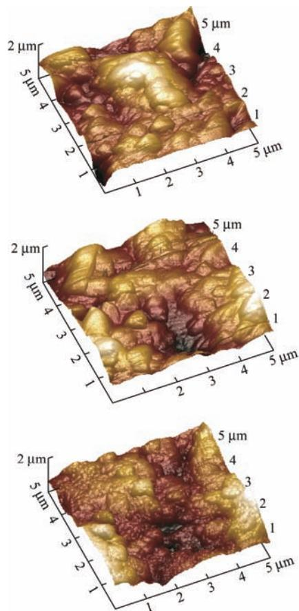
**摘要:**采用原子层沉积技术(ALD)在200 °C低温条件下将纳米  $\text{Al}_2\text{O}_3/\text{TiO}_2$  多层涂层沉积在硬质合金刀具表面。利用扫描电镜SEM、划痕测试仪和三向测力仪以及数控机床等设备,对不同形式的纳米  $\text{Al}_2\text{O}_3/\text{TiO}_2$  多层涂层刀具的涂层-基体结合力和切削性能等进行研究。结果表明,基于原子层沉积技术低温制备的纳米多层涂层刀具的涂层-基体结合强度高;涂层层数、涂层沉积顺序及涂层层厚比对纳米多层涂层刀具的切削力有不同程度的影响;纳米多层涂层刀具更适合高速切削,当切削速度大于2.33 m/s时,纳米多层涂层刀具的切削力和摩擦因数呈下降趋势,表现出良好的切削性能,其中双层纳米涂层刀具的切削性能更好;在高速切削时,纳米多层涂层刀具表面摩擦因数比普通未涂层硬质合金刀具低,纳米  $\text{Al}_2\text{O}_3/\text{TiO}_2$  多层涂层能够有效改善刀具的黏结磨损,减少刀-屑粘黏现象和烫伤现象,能够改善刀具表面的耐磨损性能。
