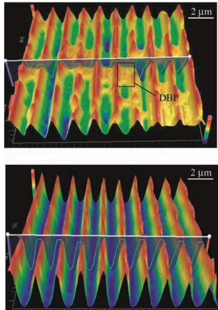
**摘要:**高能量激光装置中衍射光栅吸附的有机污染物是导致衍射光栅损伤的关键因素之一,采用等离子体清洗技术可以实现衍射光栅表面污染物的在线去除。通过有限元方法分析等离子体清洗范围,获得等离子体清洗半径随着清洗距离下降而增加的规律。研究等离子体清洗工艺参数与表面有机污染物去除效果间关系,结果表明随着清洗距离以及工艺气体中氧气含量的上升,镀铝衍射光栅表面自由能的极性部分和色散部分都会增加,其中极性部分的增加起主导作用。等离子体清洗后的镀铝衍射光栅表面呈现洁净状态的周期性锯齿形结构,并且C1s(285.0 eV)峰值由 $6.65 \times 10^4$ 降低至 $2.86 \times 10^4$ 。研究等离子体清洗镀铝衍射光栅后表面自由能变化情况,结果表明镀铝衍射光栅表面的极性基团会吸附空气中的碳氢化合物,出现表面自由能下降的陈化现象。研究结果可为镀铝衍射光栅表面有机物污染物的等离子体在线去除提供新的途径。
