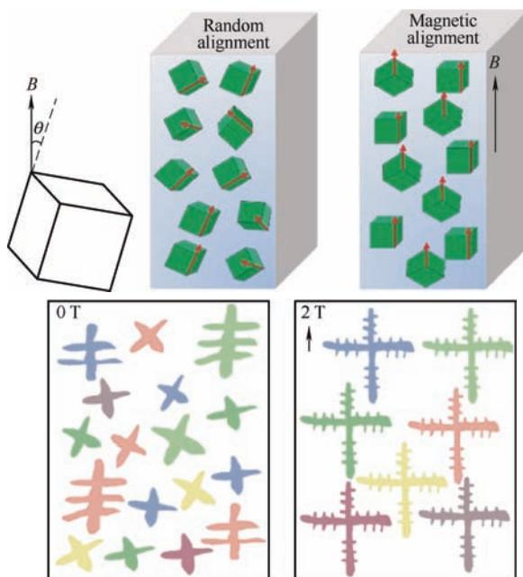
**摘要:**利用磁场辅助金属凝固,不仅可以细化晶粒、改善凝固组织的力学性能,同时由于磁场和熔融态金属是非直接接触,还可以避免缺陷的引入,进而已成为研究热点。针对磁场作用下的金属熔体形核和晶核生长特点,对金属凝固过程进行深入分析,从磁场对金属凝固的影响原理和仪器设备两个方面进行总结,综述磁场作用下金属凝固的研究进展;分别从铁磁性、顺磁性、抗磁性三种磁性金属在磁场作用下试验研究进行梳理分析。结果表明:磁场引发的洛伦兹力、热电磁力、磁转矩及磁取向等作用通过影响金属熔体的形核和晶核生长,最终改善凝固组织性能;磁场设备利用永磁铁或者电磁铁产生磁场环境;三种磁性金属在磁场环境下凝固后的性能改善体现在力学性能、导电性能、磁性能等方面。最后归纳磁场辅助金属凝固过程中所存在的问题,并展望未来的发展趋势。
