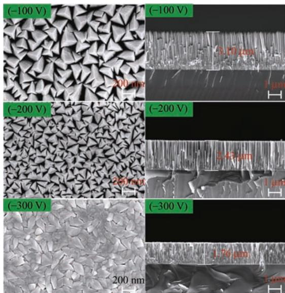
**摘要：**针对高性能CrN涂层无法实现低温可控制备的技术瓶颈，利用具备高溅射材料离化率的高功率脉冲磁控溅射技术，调控同步脉冲偏压，改善涂层生长动力学条件，实现CrN涂层的低温可控沉积。开展同步脉冲偏压与涂层化学组成、组织结构、力学、摩擦学及耐腐蚀性能间关联关系研究。同步脉冲偏压在提升沉积离子束流迁移能的同时可显著降低荷能 $\text{Ar}^+$ 对成膜表面的持续轰击作用，达到改善涂层致密性及膜基结合力的目的。此外，沉积CrN涂层晶粒细化显著，硬度及弹性模量明显升高，最高可达13.8 GPa、236.7 GPa。涂层力学性能优化及致密性提升显著改善了摩擦学与耐腐蚀性能，涂层磨耗率最低可达 $2.49 \times 10^{-15} \text{ m}^3 / (\text{N} \cdot \text{m})$ ，同时涂层可耐受120 h中性盐雾腐蚀环境考核。为实现高性能CrN涂层的低温可控制备，扩展其在温度敏感基体领域的适用范围提供了新的设计思路与技术支撑。
