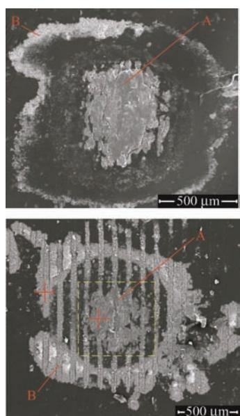
**摘要:** 在航空发动机中, 钛合金零部件的微动磨损不可避免。表面织构能在一定程度上减缓微动磨损, 然而目前对表面织构下钛合金不同周次微动磨损行为的认识尚有不足。在 TC4 钛合金表面通过激光加工制备不同方向的沟槽状表面织构, 随后进行不同周次的微动磨损试验。试验结果表明, 在磨损的初期, 有垂直方向表面织构的样品微动循环图更“瘦长”; 随着磨损的进行, 磨屑的分布状态发生了改变, 其微动循环图变的和平行织构的样品以及无织构的样品相同。整个磨损过程随微动周次增加, 分为黏着阶段和稳定阶段, 垂直织构的样品上, 黏着阶段又可被细分为黏着区域分散的阶段和黏着区域成片的阶段。随周次增加, 磨屑的演变是由大块的磨屑层经不断被碾碎、氧化, 转换成小块的磨屑, 并且最终转换成细小的颗粒磨屑, 被排出到磨损区域之外。研究结果对认识微动磨损行为中不同周次下表面织构的作用及磨屑的演化具有一定理论意义。
