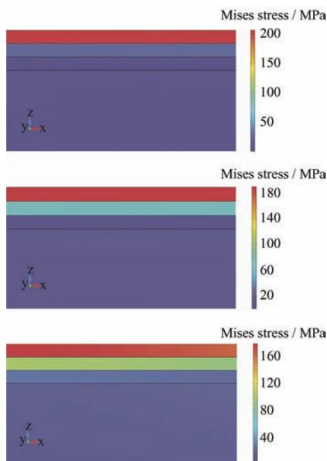
**摘要:**针对复合涂层的现有仿真方法多基于单一物理场的影响,不能反映多物理场耦合作用等实际工况下的力学性能。以航空发动机附件机匣的典型工况环境为背景,建立描述流-固-热耦合作用下梯度复合涂层各物理参数变化的数学模型,计算涂层不同分布方式下其内部的 von Mises 应力分布。结果表明,过渡层材料组分的渐变方式对涂层热应变和层内 von Mises 应力分布有较大影响,以航空发动机附件机匣中某型花键副为例,在施加实际工况下的载荷和温度条件后,温度场引起的热应力较载荷-润滑引起的应力更大,在润滑、热场和载荷的耦合作用下,三种分布方式的涂层最大应力均位于表层,随梯度的增大逐渐向基体扩散;梯度增大的过渡方式在涂层内可以获得最小的最大 von Mises 应力。在所关注的温度范围内,与梯度减小的过渡方式相比,使用梯度增大的过渡方式可使最大 von Mises 应力减小 14.5%。所建立的仿真方法可模拟近似实际工况,研究结果可用于指导梯度复合涂层的设计和制备。
