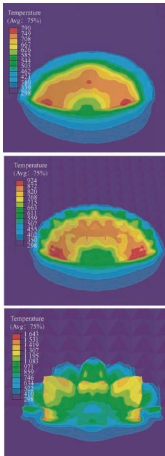
**摘要：**在冷喷涂过程中，基体的表面粗糙度会影响涂层和基体之间的结合，目前对该问题关注还不够，且存在一定争议。以冷喷涂修复 Ti6Al4V 钛合金（TC4）过程为研究对象，利用有限元模拟手段，建立二维和三维单粒子在不同表面粗糙度基体上的撞击模型。通过分析粒子在撞击到光滑表面、研磨表面和喷砂表面三种情况下界面的温度、等效塑性应变及系统能量的变化，得出以下结论：随着基体表面粗糙度的增加，粒子的等效塑性应变和扁平率逐渐减小。界面温度和等效塑性应变在基体“波峰”处较高，在“波谷”处较低，在高的表面粗糙度下，粒子的塑性变形减弱，反弹趋势增强。研究结果表明，对冷喷涂 TC4 修复过程而言，基体的粗糙化不利于涂层与基体的结合。研究结果 nT 可为冷喷涂修复钛合金过程中基体预处理方式的选择提供理论指导。
