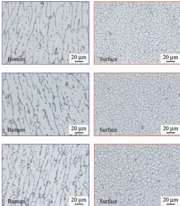
**摘要:** 工艺参数的协同调控决定了沉积工件的组织与性能, 在锻造铝合金零件激光增材修复工程应用方面具有重要研究价值。采用 OM、SEM、XRD 等试验方法, 研究能量密度对激光沉积成形 2A50 铝合金构件组织与性能的影响规律。结果表明: 当能量密度低于  $200 \text{ J} / \text{mm}^2$  时, 成形效果较差且产生粉末球化、未熔合等凝固缺陷; 随着能量密度的提高, 沉积试样底部和顶部一次枝晶间距均明显缩短、平均硬度由 85.7 HV 提高至 92.1 HV; 过高的能量密度输入会导致熔池内部分低熔点合金元素蒸发形成气孔缺陷、同时削弱了合金元素的固溶强化效果。在优化的能量密度 ( $333 \text{ J} / \text{mm}^2$ ) 条件下, 激光沉积成形 2A50 锻造铝合金构件获得了较优的综合力学性能, 其屈服强度、抗拉强度和延伸率分别为 85 MPa、207 MPa 和 14%。为航空重大装备关键零部件的激光增材修复探索出一条行之有效技术途径。
