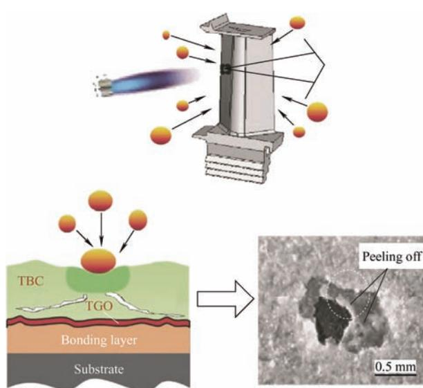
**摘要:**航空发动机高速发展,其服役工况日渐严苛。飞机在高低空飞行、起飞和降落过程中,空气中的沙粒、火山灰、雨水和冰晶等在高速气流作用下不可避免地被吸入发动机内,与燃烧室等热端部件工作过程中产生的高温多相冲蚀流体共同作用,造成各类冲蚀损伤并严重影响航空发动机服役期间的安全性。开发有效的航空发动机冲蚀防护技术及高性能冲蚀防护涂层已成为航空发动机安全服役的必要保障,但目前系统介绍航空发动机冷热端部件冲蚀损伤形式的文献极少。针对航空发动机服役环境下冷热端部件的主要冲蚀形式及产生原因进行归纳,分析航空发动机服役工况特点与冲蚀破坏机理。对航空发动机用抗冲蚀涂层体系进行归类,并对其研究进展及性能进行阐述,归纳航空发动机冲蚀防护领域的测试方法和国内外各学术团队的探索性研究。总结当前研究成果并作以展望,为航空发动机冲蚀损伤的研究和新型防护涂层的设计提供参考。
